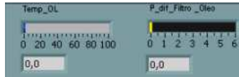
Figura 39 – Indicadores de variáveis que tem sua cor alterada quando atinge um valor pré determinado
