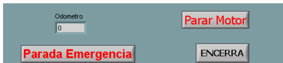
Figura 35 - Representação dos comandos locais da Parada em emergência, parada normal do motor e encerramento do programa.
